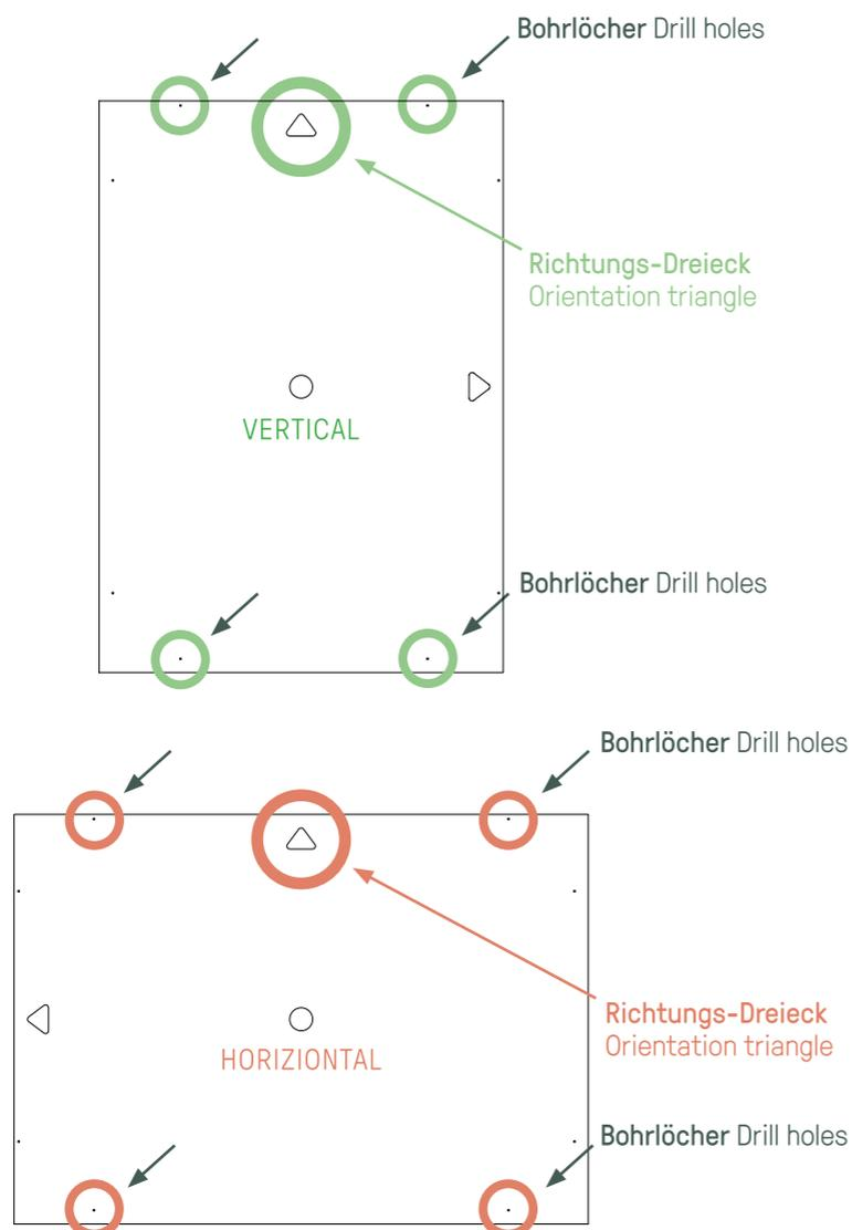
**2** Nimm die Schablone von der Wand und bohre an den 4 markierten Stellen Löcher mit einem 8 mm-Bohrer. Setze danach die mitgelieferten Dübel ein und drehe die dazu gehörigen Schrauben ein. **Achte bitte darauf, dass zwischen Schraubenkopf und Wand etwa 2 mm Abstand ist** (etwa die Dicke einer 1 Euro Münze).
